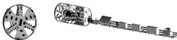
图 4 AVND 2400 机器、切割刀盘以及辅助隧道设备
