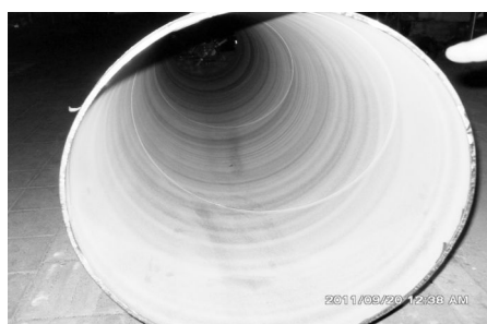
图 3 喷砂清理效果图
