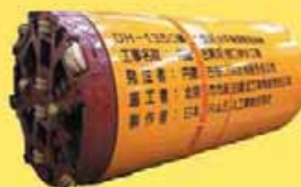
内蒙古磴口供水工程—穿越黄河 (卵石型)
